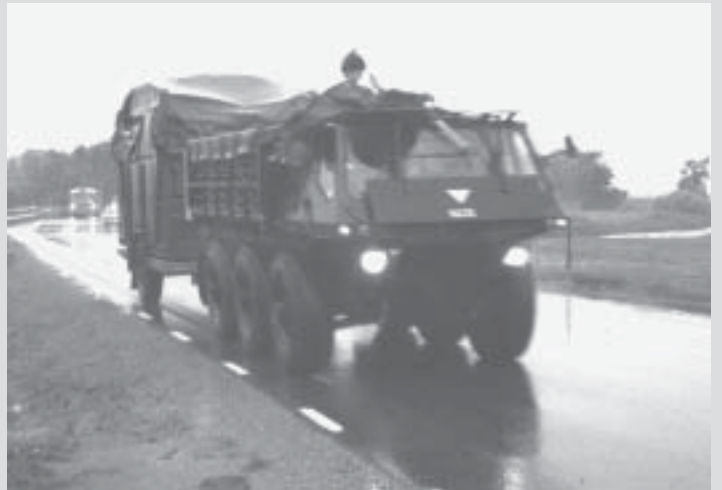
Amfibiebil 101 drar Arte 719. Bilen var försedd med en åtta-cylindrig bensinmotor på 220 hk från Rolls Royce och inköptes i sammanlagt 34 exemplar i slutet av 1960-talet från Alvis i Storbritannien.
