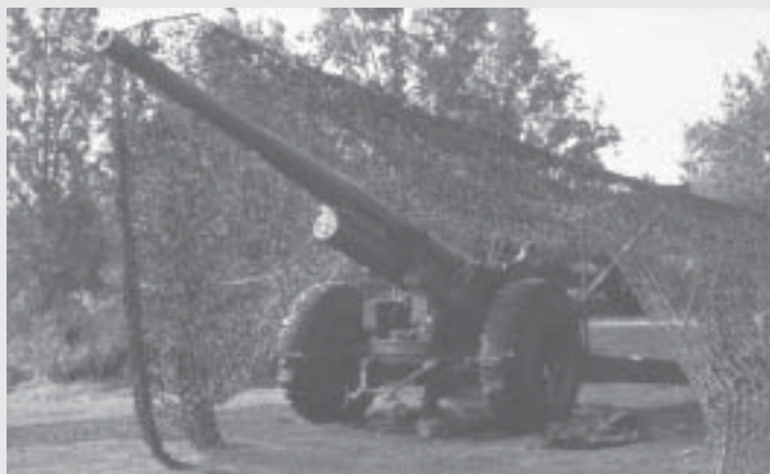
15,2 cm kustartilleripjäs m/37 i hög eldberedskap. Omläggning genomfördes i allmänhet på pjäsens grupperingsplats, varför det erfordrades utrymme för dragfordon och eldrörsvagn intill lavetten, vilket framgår av denna bild. Lavetten var inte dimensionerad för körning i terräng med sammansatt pjäs
