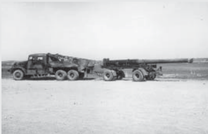
Dragterrängbil 954, Brockway. Cirka 100 fordon inköptes och fi ck i Sverige olika utföranden, till exempel som dragterrängbil med hytt för tre eller tio man, som bärgnings-terrängbil och kranterrängbil. I grundutförande vägde den tolv ton och var försedd med en sexcylindrig bensin-motor på 202 hk.
