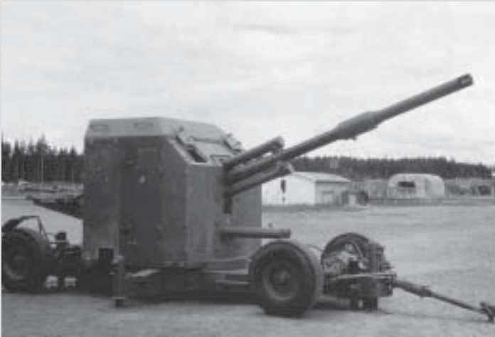
7,5 cm kustartilleripjäs m/65 med monterat splitterskydd. Detta vägde cirka 1,5 ton och monterades efter gruppering. Lavetten var inte dimensionerad för körning i terräng med monterat splitterskydd. Splitterskyddet gav bemanningen skydd mot finkaöibrig eld och granatsplitter. Det var inte gastätt.
