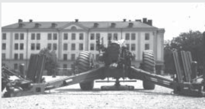
Moderniserad 15,2 cm kustartilleripjäs m/37 med gummihjul och pivåplatta. En stor del av pjäsens vikt vilade på pivå-plattan, vilket underlättade svansning. Bemanninge bestod av femton man. Kanonen står grupperad på KA 2:s kasernområde i Gräsvik i Karlskrona. Detta kasernområde byggdes 1902–1904 för Karlskrona grenadjärre gemente, som lades ned 1927. Kasernområdet utnyttjades därefter av ett detachment ur I 11, benämnt I 11K.
