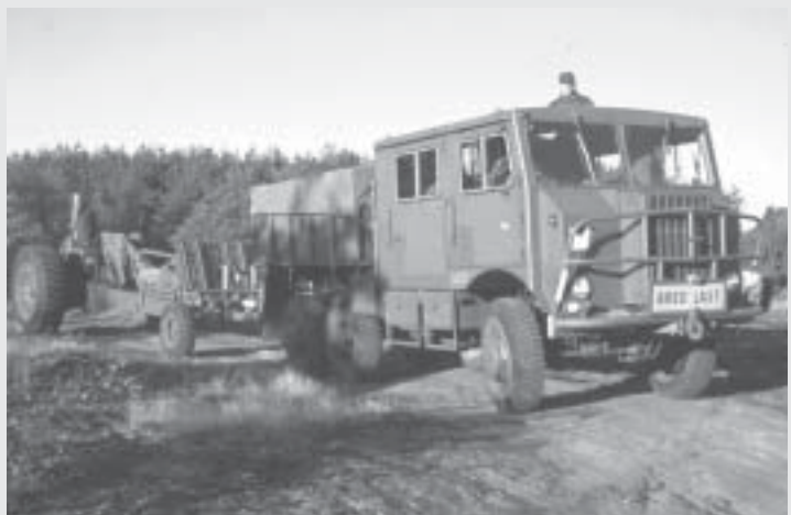
Dragterrängbil 953B. Volvos dragterrängbil m/42 har moderniserats med en ny och högre hytt, en ny bensinmotor på 160 hk och tryckluftsservo. För att den nya motorn skulle få plats flyttades kylaren fram 20 cm.
